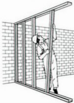
8. Montarea profilelor CW.
