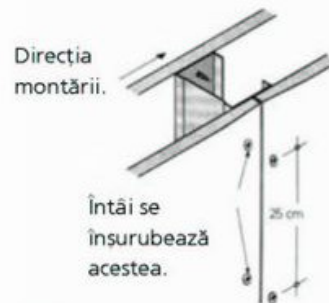
13. Ordinea de fixare cu șuruburi:
