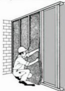
10. Aplicarea stratului de izolare (vată minerală).
